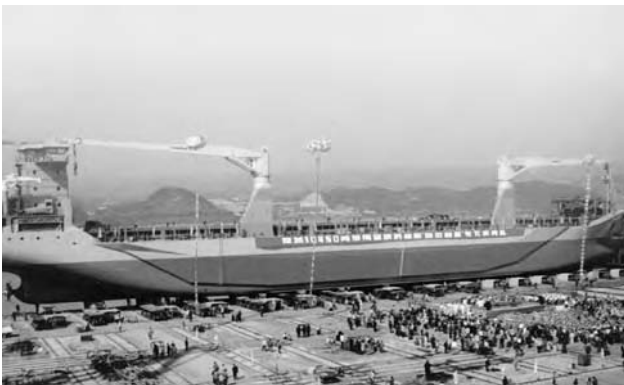
obr. 54 - Nákladní říční námořní loď před spuštěním na vodu v loděnicích Yichang v roce 2002. Rozměry 145,6 x 18,25 x 10,3 m, nosnost 10 500 t
