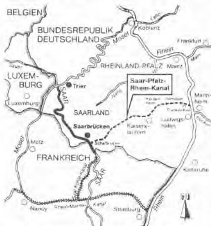
Obr. 1 – Situační schéma dvou variant napojení Sárška na síť evropských vodních cest, tj. splavnění Sáry (silně plně) a průplavního napojení přímo k Rýnu (silně čárkované)
