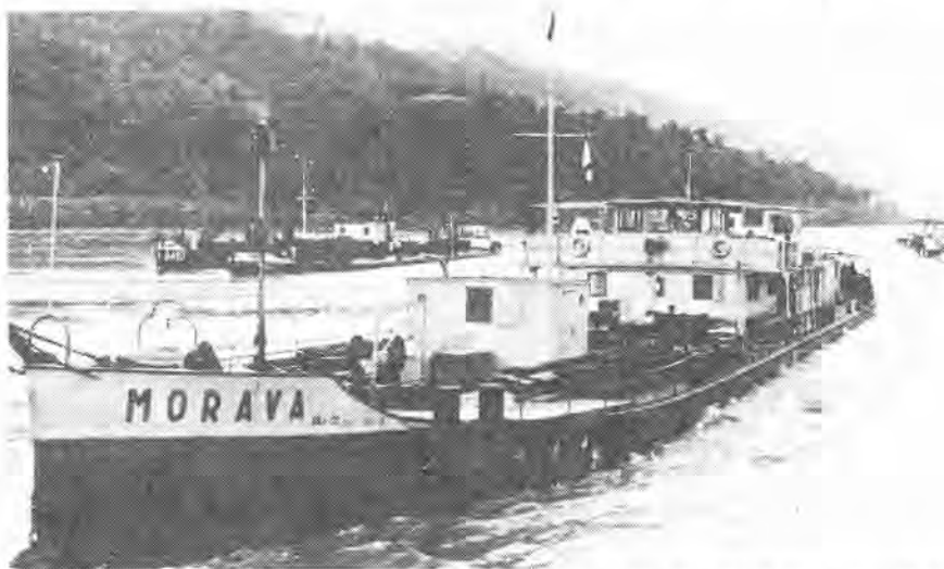
Obr. 3 – Motorová tanková loď Morava (býv. Vajanský ) ze série tří lodí tohoto typu o výkonu 1050 k a nosnosti 500 t, postavených v SZ Komárno pro ČPSD v roce 1937
