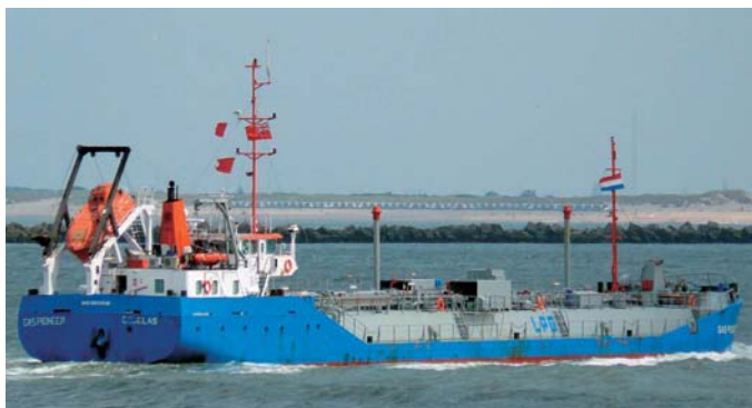
Menší říčně-námořní loď na přepravu 2\,500\text{ m}^3 kapalného plynu, tj. 1\,500\,000\text{ m}^3 plynu.
