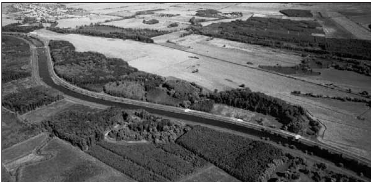
Upravená řeka Morava mezi Hodonínem a Lanžhotem vedená podél komplexu lužních lesů představuje téměř hotovou trasu vodního koridoru D-O-L. Provizorní pevné a vakové jezy budou nahrazeny pohyblivými jezy, aniž by byl podstatně změněn dosavadní hladinový systém. Směrové poměry (poloměry oblouků) plně vyhovují plavbě.
