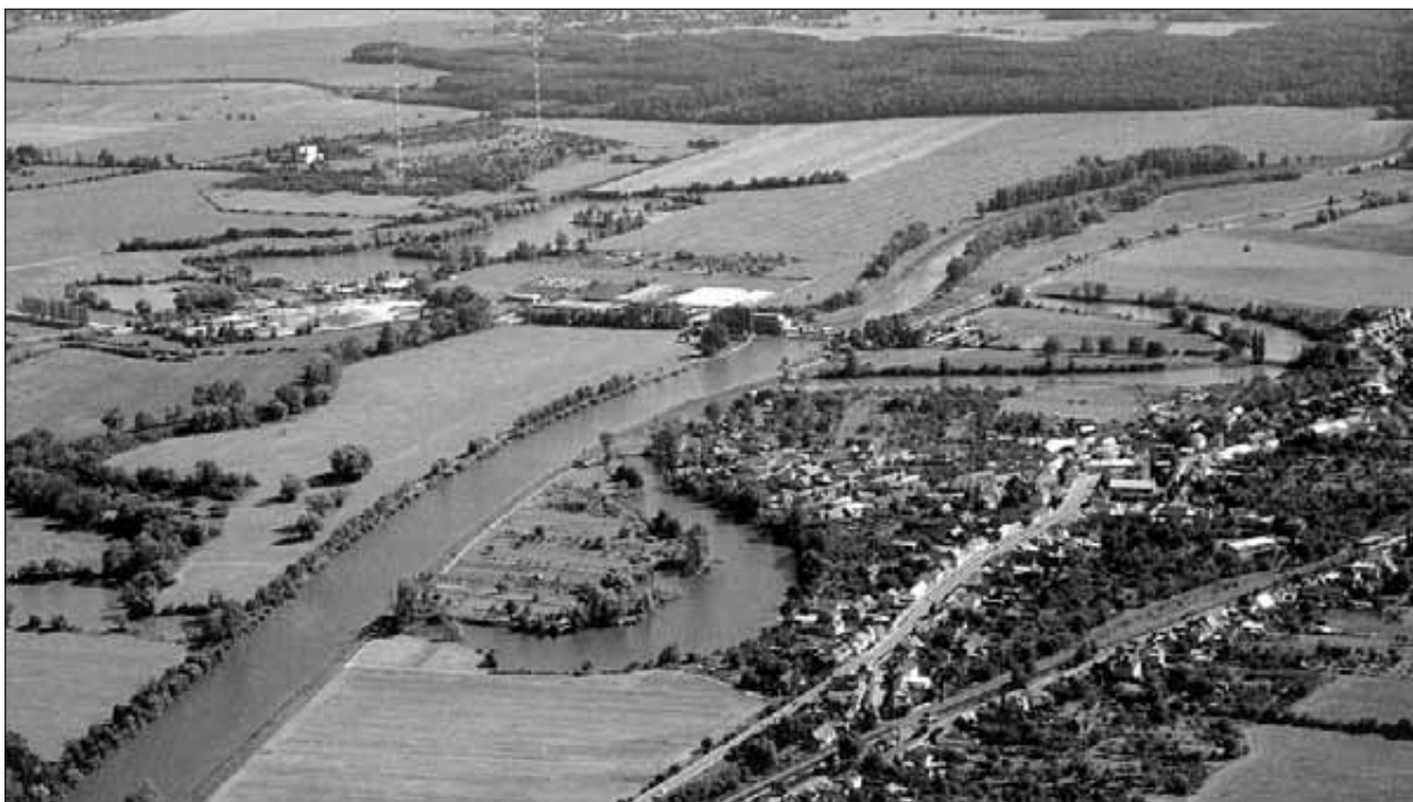
Jez Spytihněv, zřízený v rámci výstavby Baťova kanálu, vytváří zdrž, sahající až po Otrokovice, s parametry odpovídajícími vodní cestě třídy Vb. U jezu z řeky odbočuje vpravo Baťův kanál.
