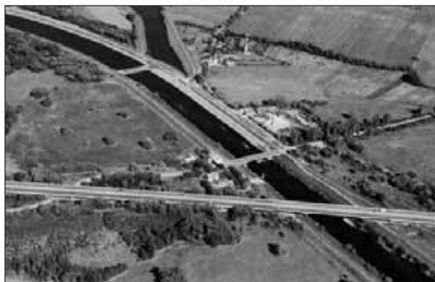
Upravená řeka Morava mezi Hodonínem a Lanžhotem vedená podél komplexu lužních lesů představuje téměř hotovou trasu vodního koridoru D-O-L. Provizorní pevné a vakové jezy budou nahrazeny pohyblivými jezy, aniž by byl podstatně změněn dosavadní hladinový systém. Směrové poměry (poloměry oblouků) plně vyhovují plavbě.
