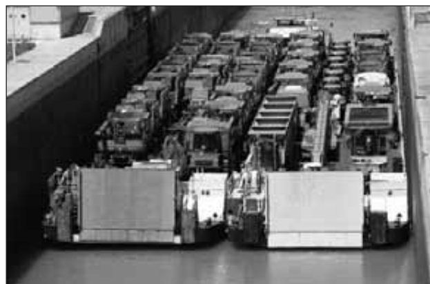
Tlačná souprava s nákladem zemědělských strojů na Dunaji proplouvá pl. komorou Freudenau
