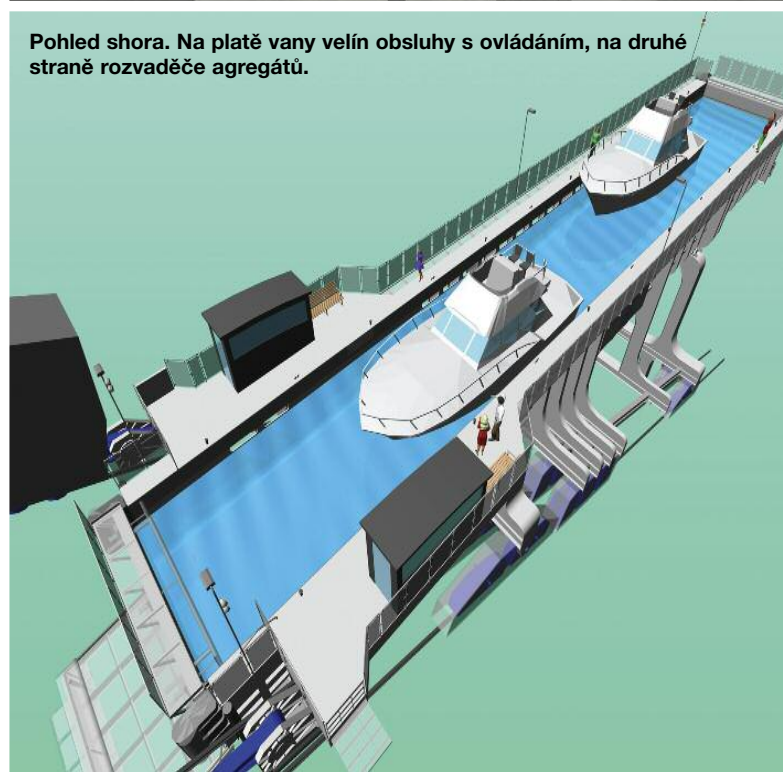
Seříznutý pohled včetně spodní stavby. Modře táhlo spojující vanu s pohonnými jednotkami.
