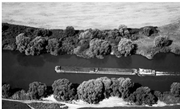
Lodní souprava s nákladem 1000 t na kanalizované Odře
