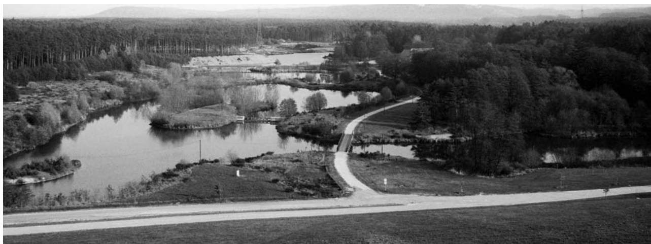
Řízení vody do vodohospodářského systému průplavu Mohan-Dunaj pod nádrží Brombach má v některých případech tvar umělých a vzájemně propojených jezírek
