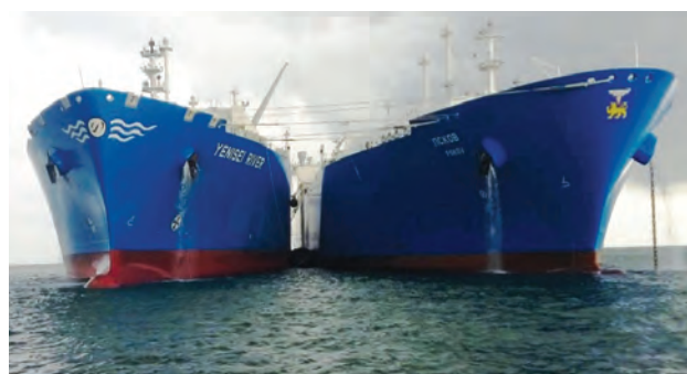
Přímá překládka LNG z plynového tankeru Pskov na LNG tanker Jenisej na širém moři
