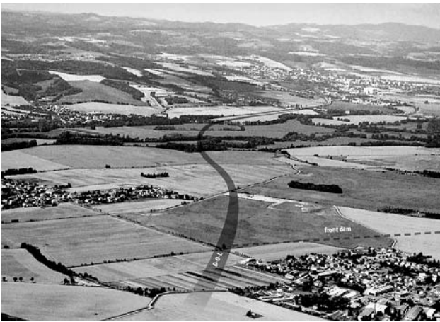
Obr. 1: Úsek vodního koridoru D-O-L mezi obcí Dubicko (v popředí) a městem Zábřeh na Moravě (v pozadí). Trasa prochází – jak snímek dokumentuje – převážně ornou půdou, jen krátce protíná údolní nivu Moravy a řeku samotnou překračuje průplavním mostem. Tento úsek je vlastně typický pro charakter celé trasy, která protíná ornou půdu na 48 % své celkové délky, kdežto nivních poloh se dotýká jen na 5 % své délky. Dá se při těchto proporcích hovořit o jakémsi ohrožení „romantického krajinného rázu“?
