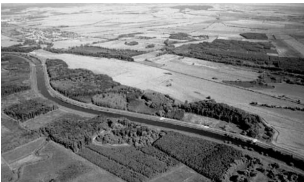
Obr. 1: Trasa vodního koridoru D-O-L mezi Hodonínem a Lanžhotem je důsledně vedena upravenou řekou, zlepšuje však hydrologické poměry ve svém okolí, zejména v SPA Soutok-Tvrdonicko (v popředí), kde by mohly být např. obnoveny vodní plochy v odstavených a vyschlých meandrech, které jsou na snímku jasně vidět.
