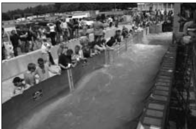
Průběh povodňové vlny umělým korytem z mobilních hrazení a náraz vlny na membránové hrazení (v popředí) a hradidlové hrazení (v pozadí)
