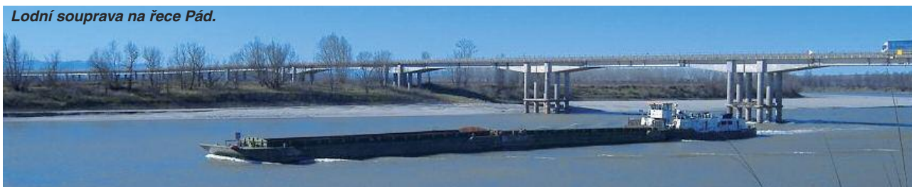
Některé mosty omezují podjezdnou výškou možnosti přeprav, především kontejnerů. Na obr. most v obci Zelo
