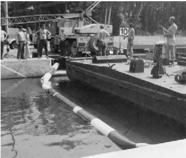
Funkční zkouška dynamické ochrany - deformovatelné táhlo po návrhovém nárazu člunu
