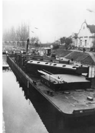
Funkční zkouška dynamické ochrany - deformovatelné táhlo po návrhovém nárazu člunu
