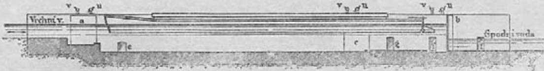
Obr. 3. Podélný řez plavidlem. Hladina v komoře ve výši vrchní vody.
