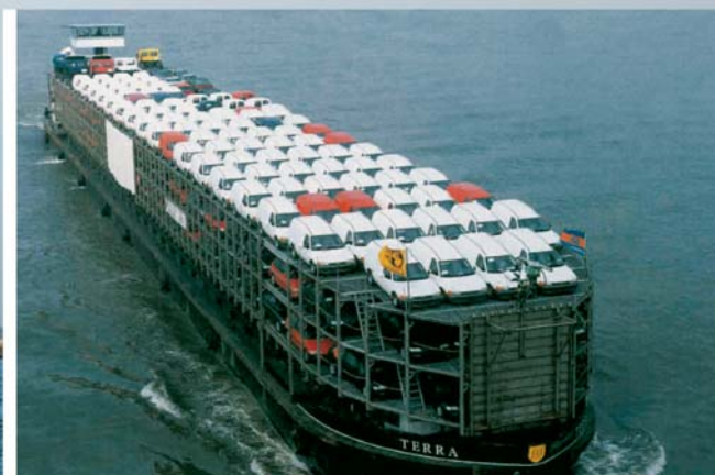
Speciální lodě na přepravu automobilů na Rýně převážejí až 600 osobních automobilů
