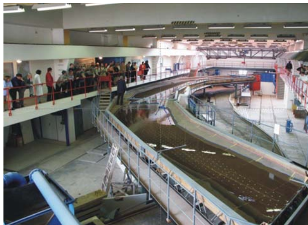
VÚV Praha – výzkum navržených plavebních objektů – model VD Děčín
