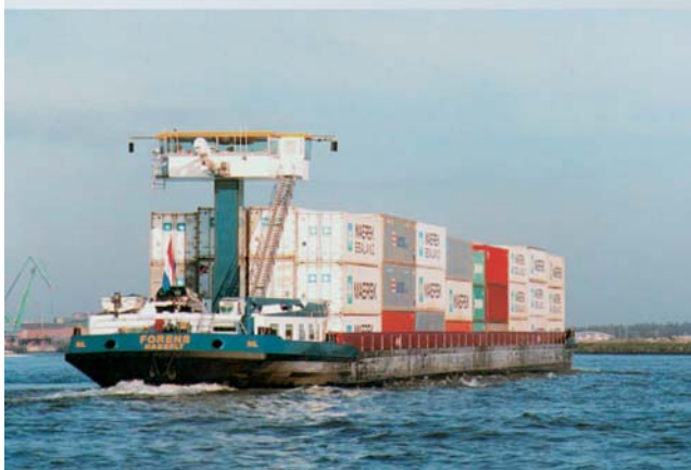
Speciální kontejnerové lodě na Rýně přepravují obvykle více než 100 kontejnerů (TEU) ve čtyřech řadách a čtyřech vrstvách
