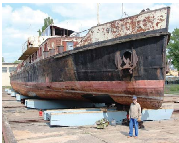
Rem. ŠTUREC uložený na pôvodných nosníkoch lodného výťahu Foto - Ing. V. Novák
