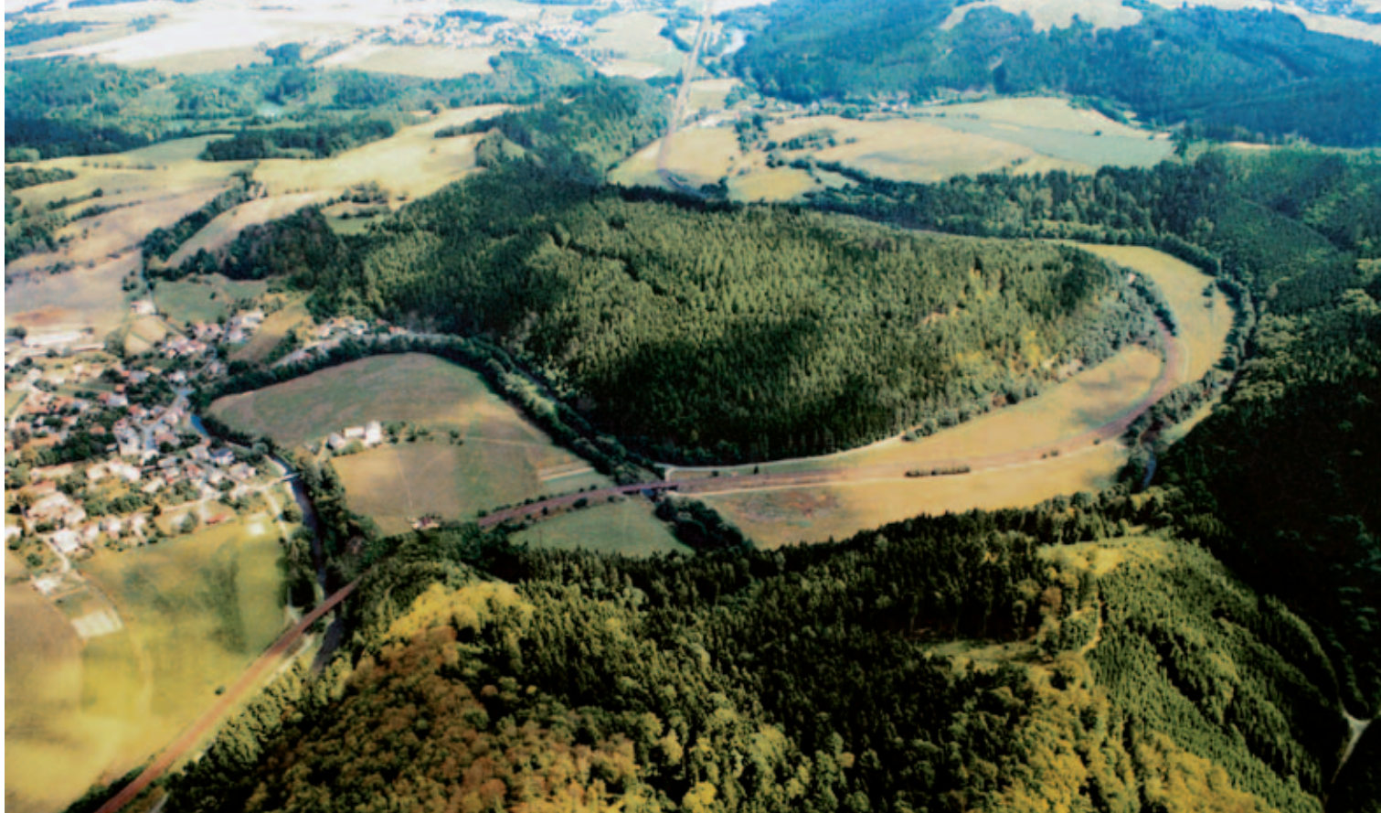
Zaklesnutý meandr Moravské Sáza- vy u Hněvkova (na snímku vlevo). Hlavní železniční trať obcházela jeho jádro za cenu oblouků s nevy- hovujícími poloměry (foto 2004).
