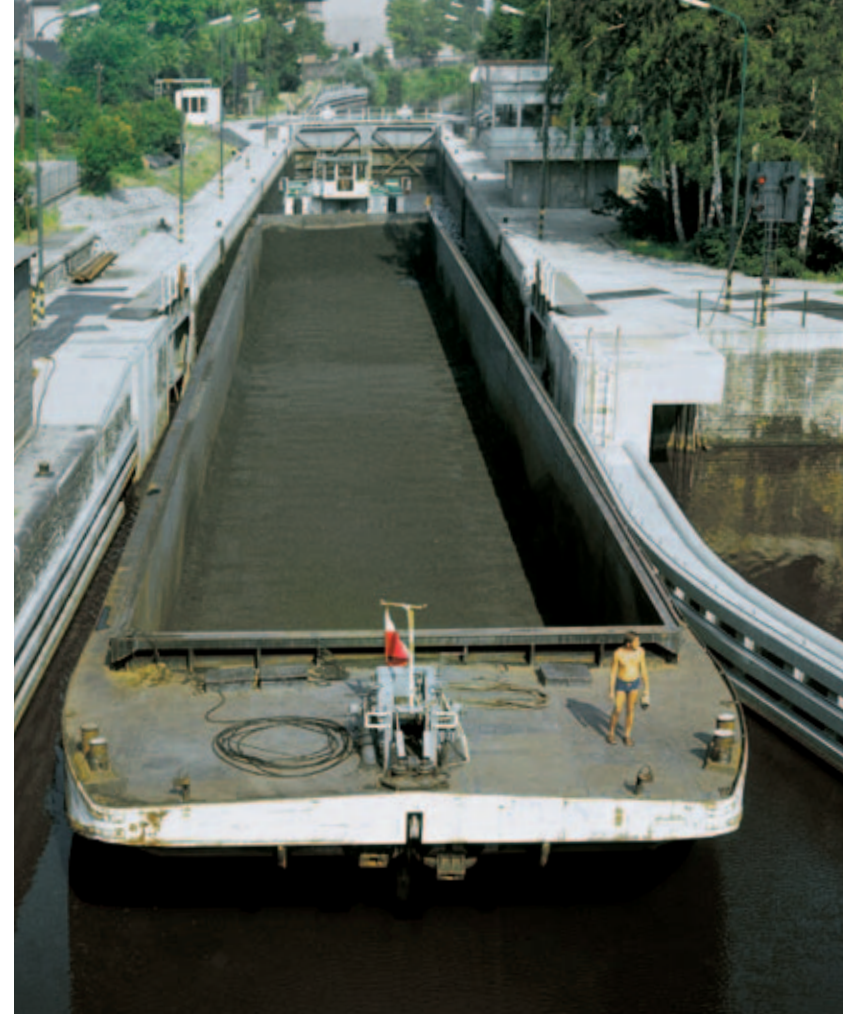
Tlačná souprava, vyplouvající z plavební komory v Kolíně na středním Labi. Tento snímek dokumentuje, že důsledné využívání unifikovaných rozměrů plavebních komor přispívá k ekonomice provozu i na vodních cestách skromných parametrů.
