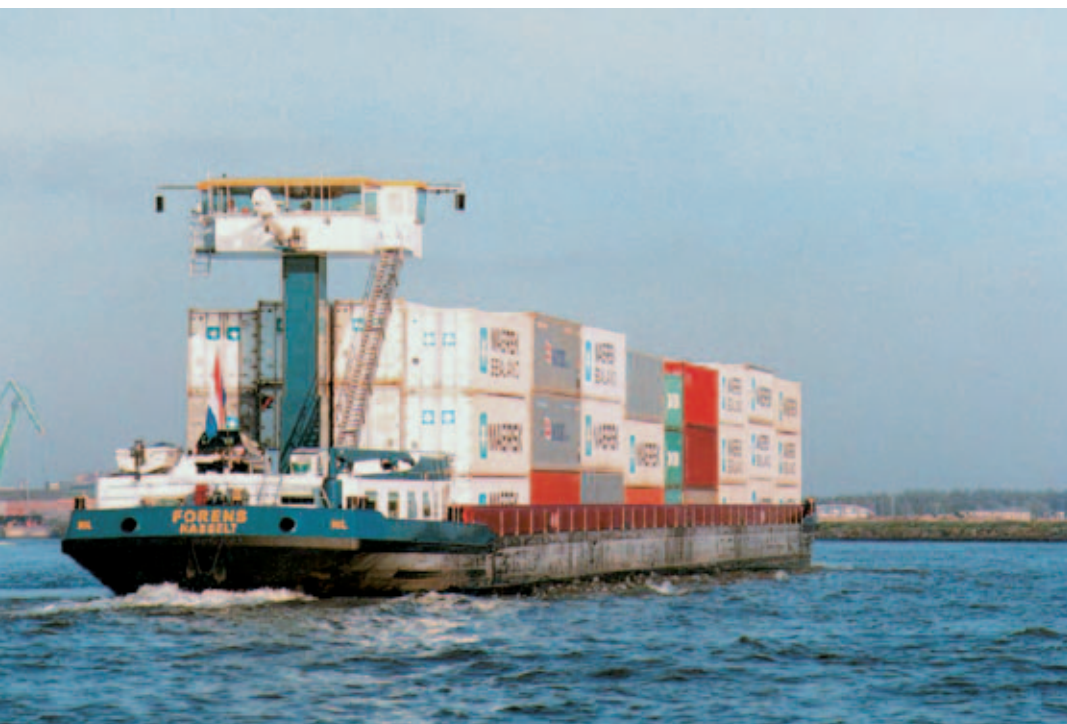
Speciální kontejnerové lodi na Rýně přepravují obvykle více než 100 jednotek (TEU) ve čtyřech řadách a čtyřech vrstvách.
