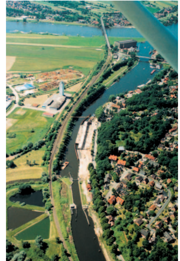
Modernizace průplavu z Labe do Lübecku. Starou plavební komoru Lauenburg (v popředí), přizpůsobenou lodím o nosnosti 1000 t, má nahradit rozestavěná nová (uprostřed), která již vyhoví lodím o nosnosti až 2500 t. Foto z roku 2005.
