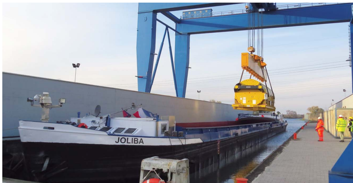
Překládka 476tunového generátoru v přístavu FAMET Opole
