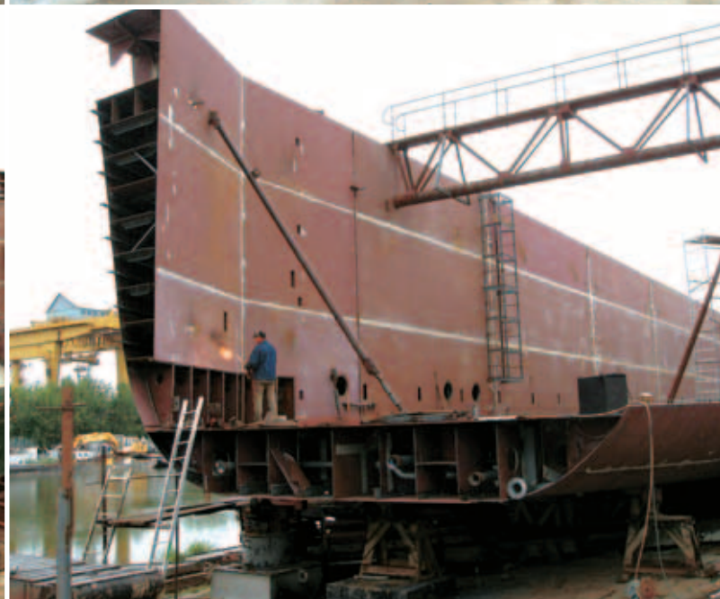
Ocelová konstrukce nástavby příbřežní lodě.
