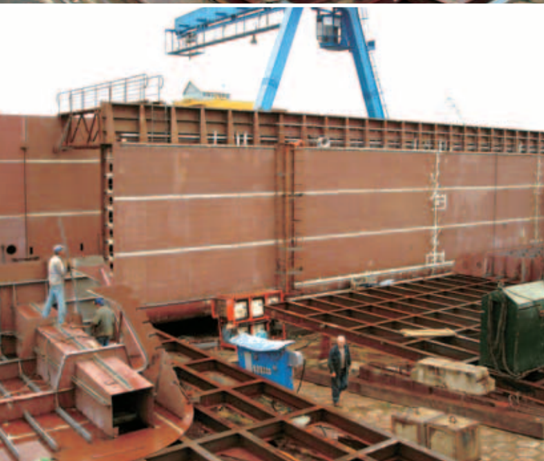
Stavba přídě příbřežní lodě.
