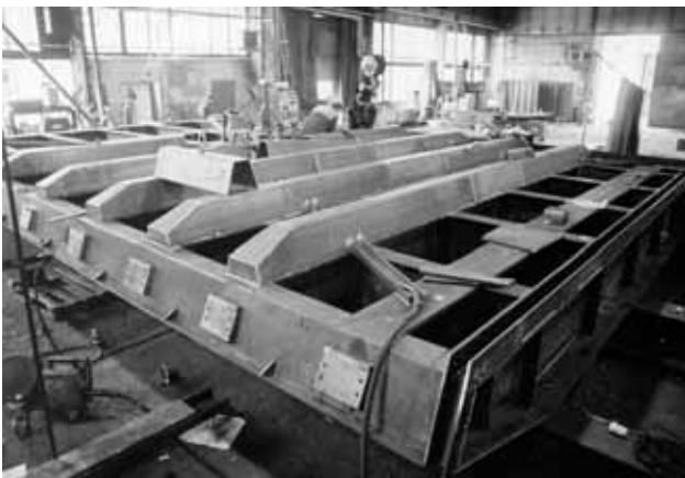
Svařování vrátně ve výrobní hale.
