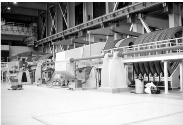
Detail pohonného zařízení. V popředí synchronizační hřídel, velká „pomalá“ převodovka a bubny s brzdami.
