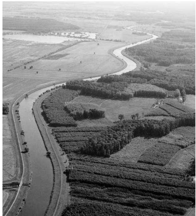
Upravená řeka Morava mezi Hodonínem a Lanžhotem může sloužit jako vodní cesta po náhradě provizorních pevných stupňů (resp. vakových jezů) definitivními pohyblivými jezy. Hladinový režim se tímto zásahem změní jen málo. Na směrové požadavky vodní dopravy bylo již při úpravě pamatováno.
