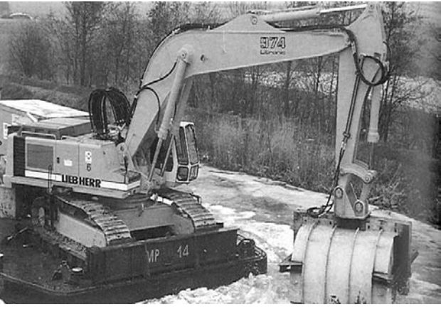
Hydraulický bagr na pontonu s tlukadlovým válcem při práci
