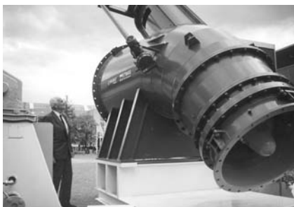
Přímoproudá turbína na mezinárodním veletrhu v Brně - návrh Záruba a Sigma Lutín 1992
