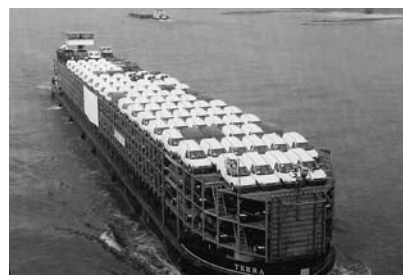
Obr. 9: Typická rýnská motorová nákladní loď, specializovaná na přepravu cca 600 osobních automobilů v šesti etážích. Stejně velkou kapacitu může mít i specializovaná souprava pro Labe, která by ovšem disponovala jen třemi etážemi.
