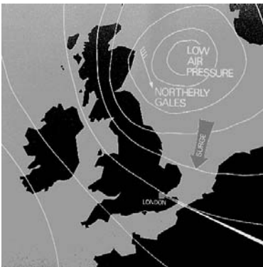
Schématický obrázek znázorňující vznik přílivových vln na Temži pod Londýnem
