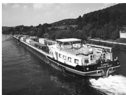
Obr. 7, 8: Tlačná souprava, tj. motorová nákladní loď a tlačný člun (což v německé terminologii znamená Koppelverband a nikoliv Schubverband – český ekvivalent však v tomto případě neexistuje) s nákladem kontejnerů na průplavu Mohan – Dunaj. Snímek názorně dokumentuje, že i při přepravě kontejnerů ve dvou vrstvách je možno ložit 160 – 200 TEU za předpokladu jednotek standardní šířky (11,4 m), umožňující ložení 4 kontejnerů vedle sebe a při dostatečné délce soupravy. Taková (ovšem asi o 30 m kratší) by měla být souprava MNL 1300 + TČ 1300 pro Labe.
