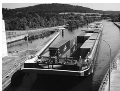
Obr. 7, 8: Tlačná souprava, tj. motorová nákladní loď a tlačný člun (což v německé terminologii znamená Koppelverband a nikoliv Schubverband – český ekvivalent však v tomto případě neexistuje) s nákladem kontejnerů na průplavu Mohan – Dunaj. Snímek názorně dokumentuje, že i při přepravě kontejnerů ve dvou vrstvách je možno ložit 160 – 200 TEU za předpokladu jednotek standardní šířky (11,4 m), umožňující ložení 4 kontejnerů vedle sebe a při dostatečné délce soupravy. Taková (ovšem asi o 30 m kratší) by měla být souprava MNL 1300 + TČ 1300 pro Labe.
