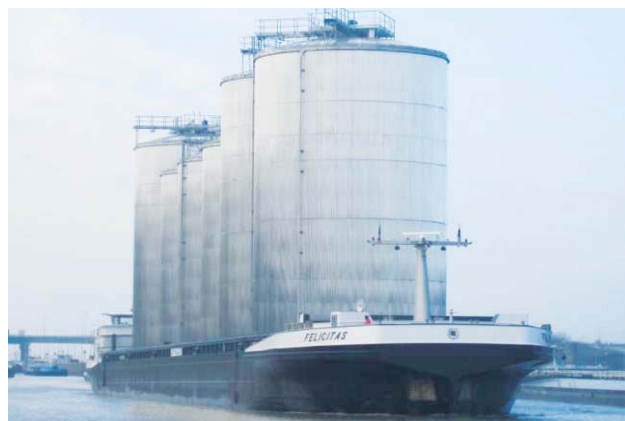
Na nizozemských vodních cestách se zvedacími mosty je možné přepravovat i velmi vysoké nadrozměrné náklady
