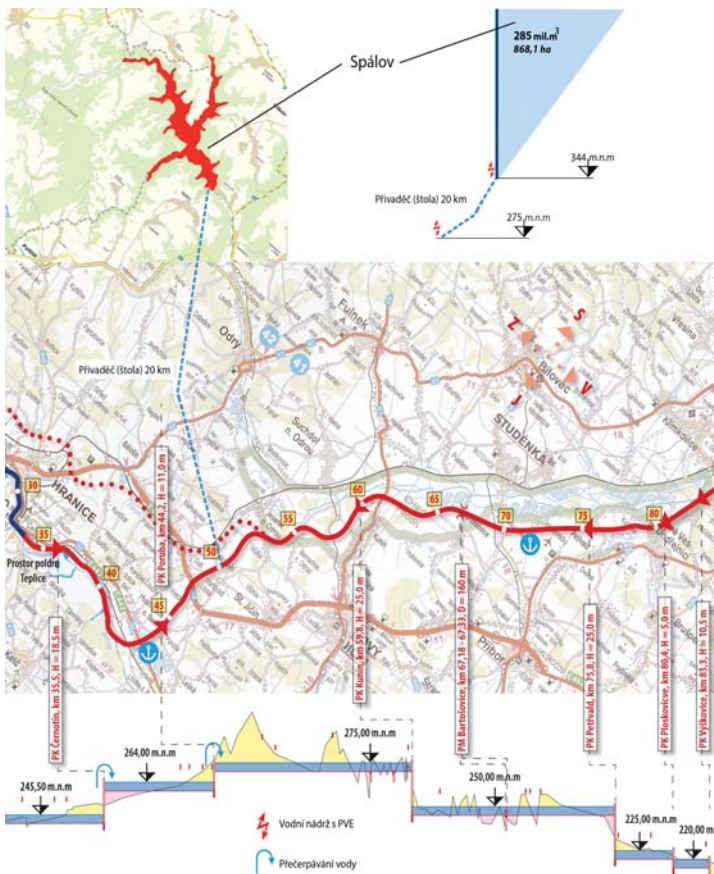
Oderská vrcholová větev vodního koridoru D-O-L s vodní nádrží Spálov (obr. 5)
