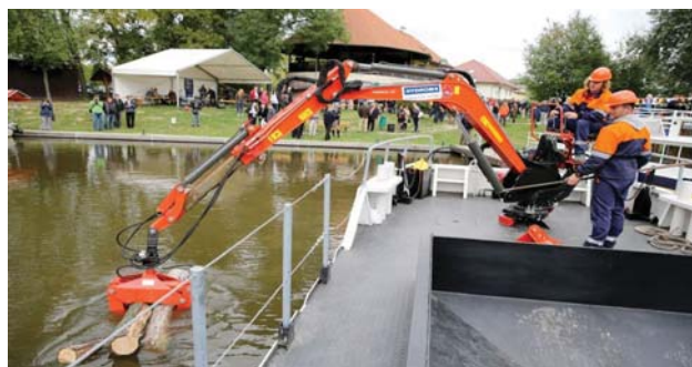
Ukázka práce lodí Jořin – vytahování klád z plavebního kanálu
