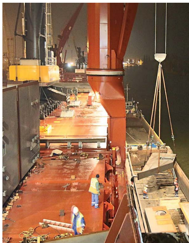
Překlad nadrozměrných a těžkých nákladů z říčního plavidla přímo na námořní loď v přístavu Štětín Zdroj: WSV
