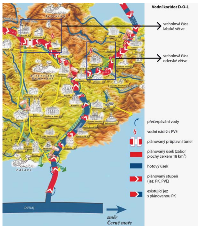
Schéma přečerpávání vody z Dunaje do vodního koridoru D-O-L (obr. 4)
