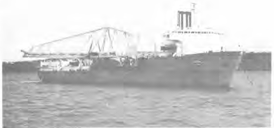
Samohybný sací bagr „Icoa“ o výkonu 10.000 m 3 /hod. je součástí technické flotily pečující o údržbu plavební dráhy na dolním toku řeky Orinoco.
