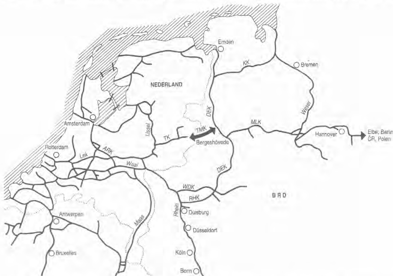
Abb. 1 Schematische Karte der Lage der TMK Verbindung im europäischen Binnenwasserstraßennetz. Nur die Wasserstraßen der IV. oder höheren Klasse werden eingeführt. • Schématická mapka, charakterizující polohu propojení TMK v evropské síti vodních cest. Jsou uvedeny pouze vodní cesty IV. nebo vyšší třídy.
