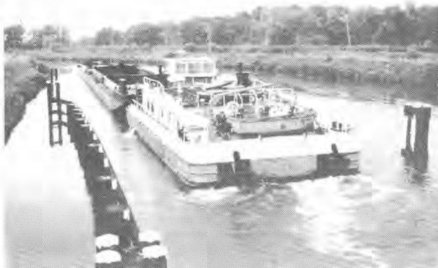
Obr. 5. Tlačný remorkér typu Bizon se dvěma čluny při plavbě proti proudu horní rejdou plavebního stupně Rogów (foto autor)
