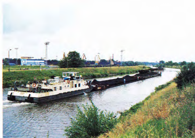
Obr. XII. Míjení plně naložené poproudni tlačné soupravy s 1000 tunami uhlí s protiproudni prázdnu soupravou v dolní rejdě plavební komory Różanka.
