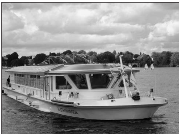
FCS Altsterwasser - První loď na vodíkový pohon typu Zemship pluje v Hamburku
