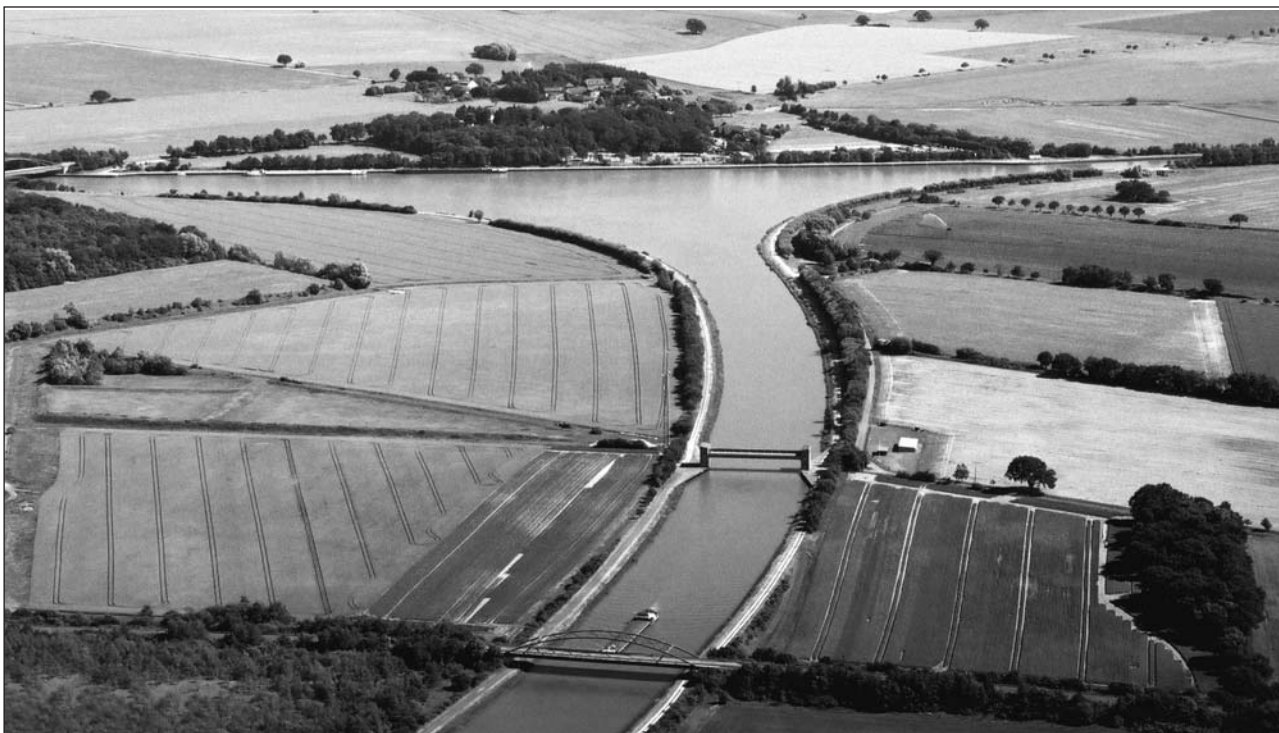
Obr. 1: Uzlový bod při odbočení Labského laterálního průplavu ze Středozemního průplavu v blízkost německého Wolfsburgu. Tak by měl vypadat souběh tří větví vodního koridoru D-O-L u Přerova, resp. u Lukové.
