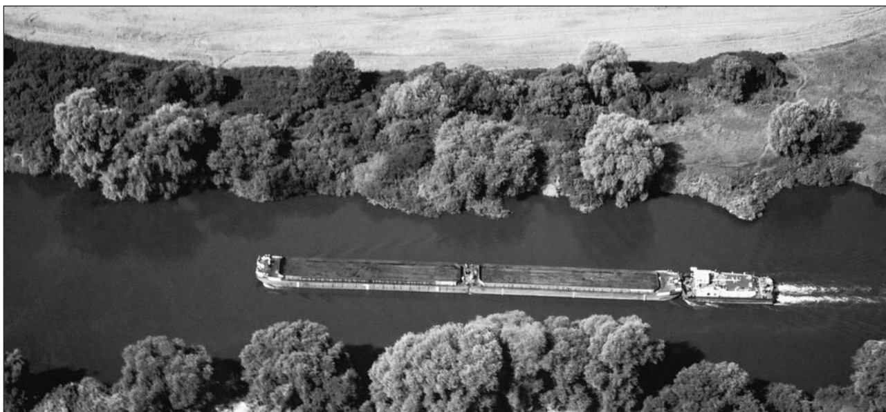
Moderní tlačná souprava na kanalizované Odře s nákladem 1000 t
