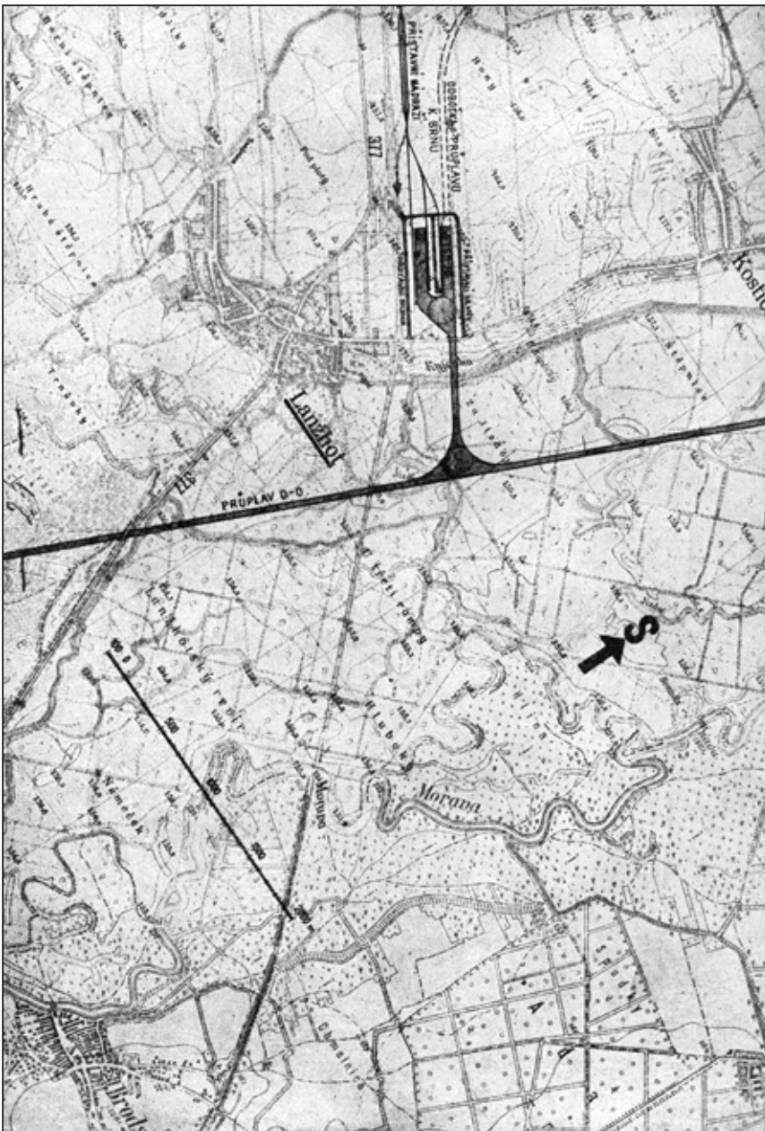
Obr. 2: Schéma přístavu Lanžhot na odbočce z průplavní trasy podle koncepce, platné v době první republiky. Na schématu je naznačeno pokračování odbočky k Brnu ze severního bazénu.
