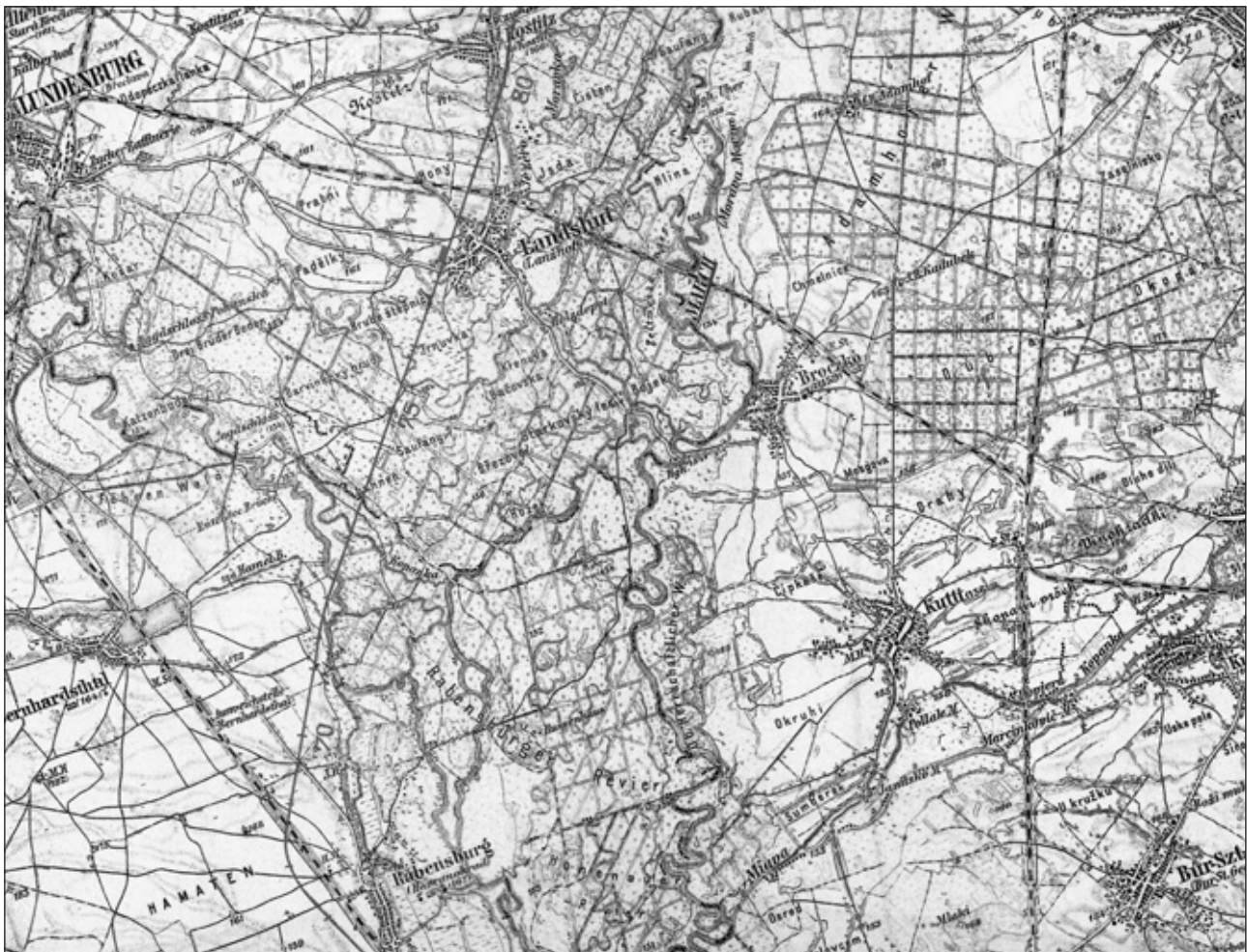
Obr. 1: Trasa propojení D-O-L podle představ, panujících na počátku 20 století, tj. po schválení vodocestného zákona z roku 1901. Průplav měl překračovat průplavním mostem Dyjí u Bernardsthalu, vysokým náspem křížovat údolní nivu mezi Dyjí a Moravou (což by bylo při dnešních požadavcích na chránění této oblasti sotva přijatelné) a procházel mezi Lanžhotem (Landshut) a Břeclaví (Lundenburg). U spojovací silnice mezi těmito městy je naznačena lokalita překladiště.
