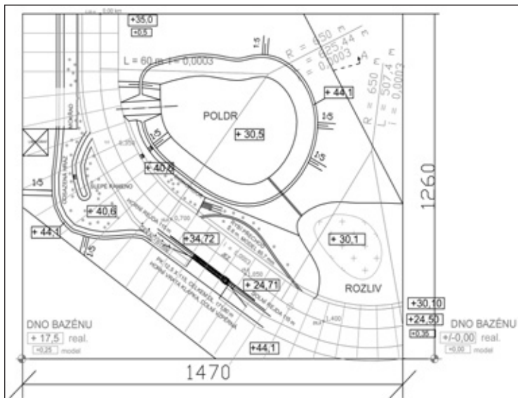
Výchozí návrh uspořádání modelu vodního toku pro expozici Protipovodňová ochrana 2009
