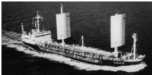
Moderní japonská tanková loď Shin-Aitoku-Maru využívá pomocné počítačem řízené kovové plachty. Princip je využít i při mobilních protipovodňových hrzení membránového typu
