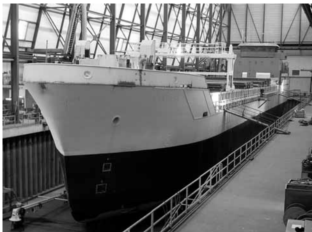
obr. 11. Mezitím je urychleně dostrojována loď Hydra v holandské loděnici. Těleso je již kompletní včetně nástaveb a kormidelny, kryty nákladového prostoru jsou usazeny a natřeny. Vůz pro manipulaci s kryty je už v provozu.
