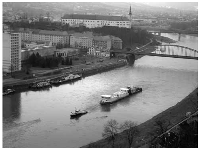
ČSPL zajišťuje speciálním tlačným remorkérem se zvýšeným zdvihem kormidelny přepravu dvou novostaveb „krmítek pro lososy“ pro norského zákazníka
