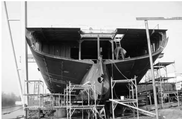
obr. 9. Shodou okolností byla tentýž den instalována v loděnici Nova v Mělníku na MS Helenic zád od žebra 07
