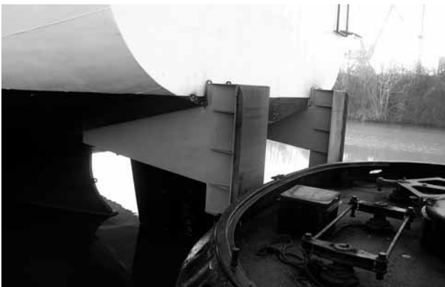
obr. 1. Pro transport byla loď hydra vybavena masivní tlačnou konstrukcí. Uvidíme ji ještě jednou na záběru ze suchého doku.
