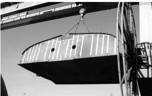
obr. 2. Ve stejné době, kdy probíhaly přípravy na přepravu MS Hydra, pokračovala stavba dalšího tělesa, nazvaného MS Helenic. Snímek ze stejného dne jako předchozí ilustruje přenos sekce kolizního prostoru do sestavy.
