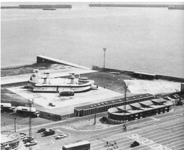
O 9 let později 11.6.1968 již operovalo na kanálu La Manche vznášedlo o nosnosti 165 tun pro 254 cestujících a 30 automobilů (D & F)
