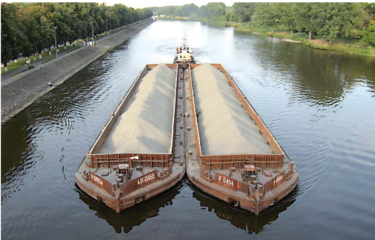
Průplav Dněpr-Bug po modernizaci plavebních komor umožní plavbu říčními a říčně-námořními lodmi až do velikosti typu Va a již nyní poskytuje podjezdnou výšku 10 metrů. Na některých úsecích, jako např. u Mikaševiči, se lodě spojují i do větších souprav
