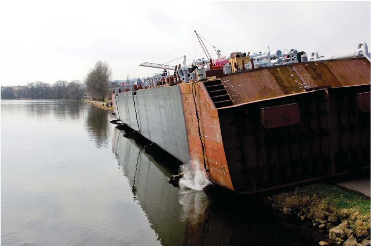
Středová část tankeru připravená ke spuštění
