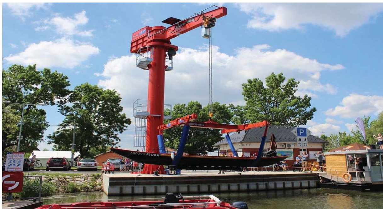
Nový stacionární jeřáb na vytahování až desetitonových plavidel na souš
