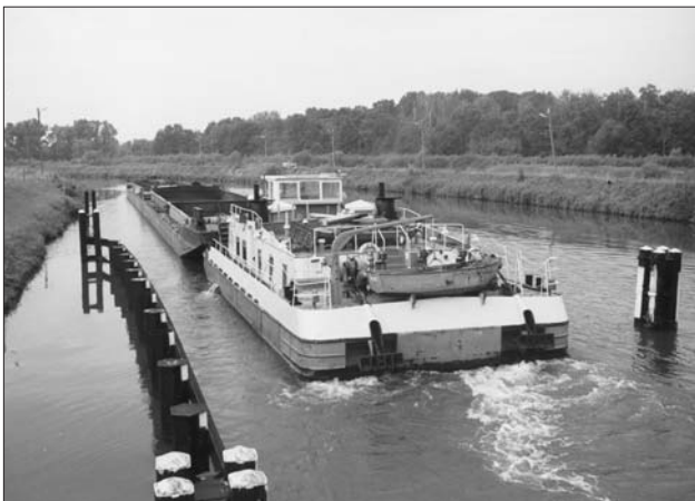
Typické tlačné soupravy na Odře jsou složeny ze dvou člunů typu BP 500 a remorkéru typu Bizon. Při ponoru 160 cm, který je na kanalizované trati zpravidla zaručen, uvezou 1 000 t.
