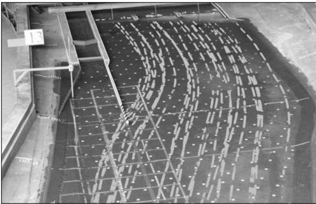
Obr. 5 - proudové poměry v horní zdrži VD Prostřední Žleb
