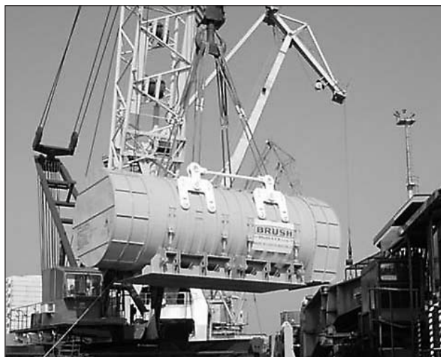
Překládka generátoru, 235 tun
