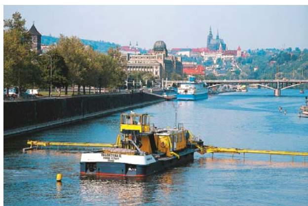
Vyměřovací loď Valentýna II vyhodnocuje plavební hloubky na labsko-vltavské vodní cestě již 24 let (1989-2012)
