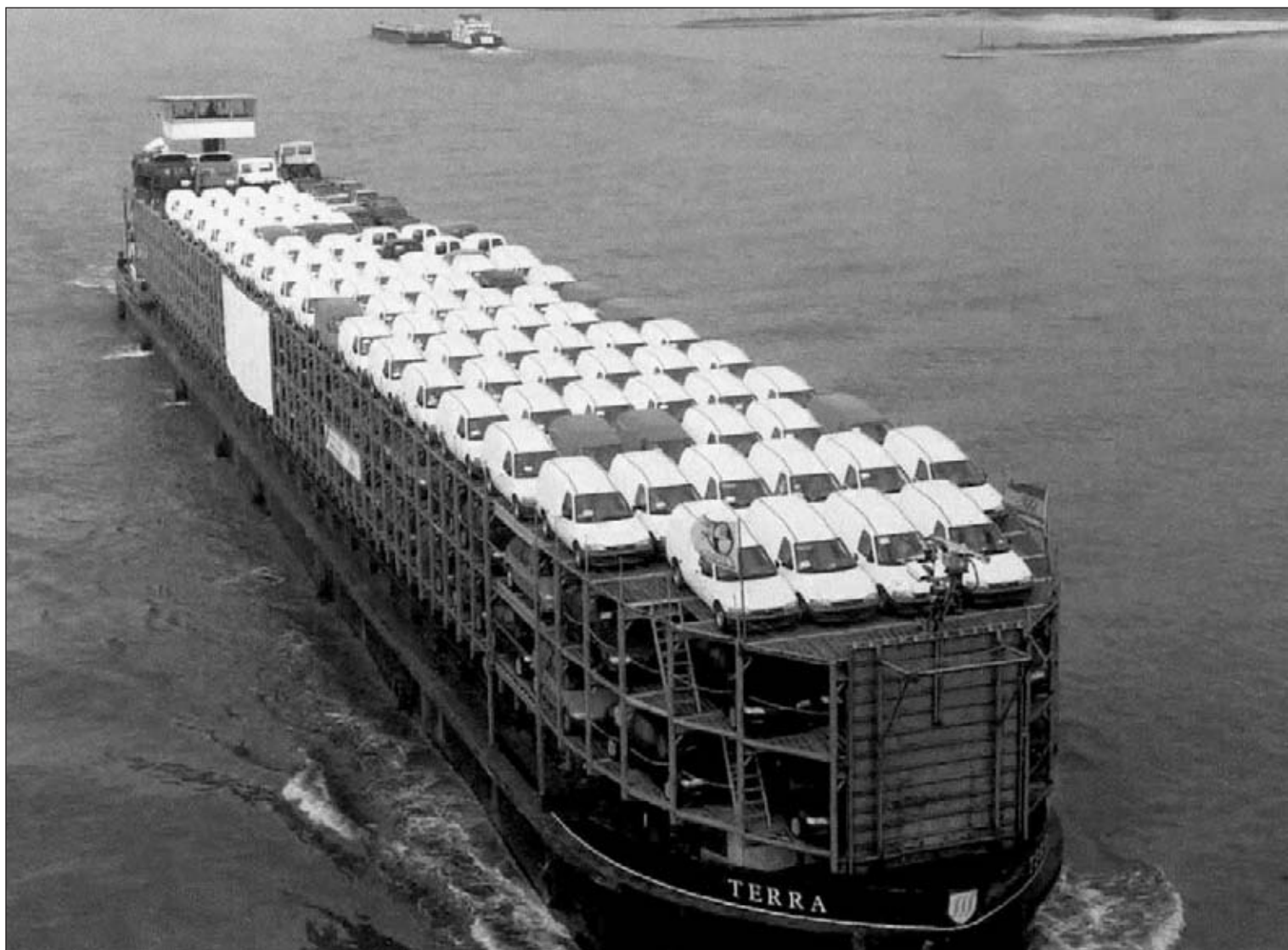
Speciální lodě na přepravu automobilů na Rýnu převážejí až 600 osobních vozů.
